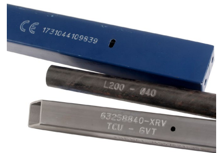
Marquage sur matières premières, peintes, enduites
