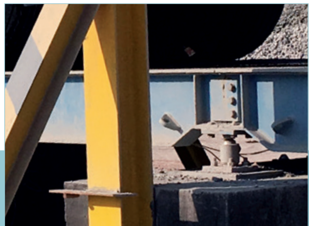
Le capteur de pesage PR 6221 pour pont-bascule garantit des résultats de mesure précis, une longue durée de vie et une rentabilité exceptionnelle
