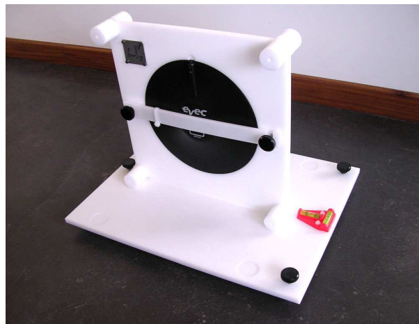
Figure 9: Positionnement d'un dosimètre "siège" sur le support capteur.
